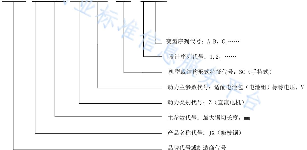
示例：\*\*JX200Z36SC-1A——\*\*品牌或\*\*制造商生产的、最大锯切长度为 200 mm、以标称电压为 36 V 的电池包（电池组）供电、直流电机驱动、结构形式为手持式、第一次设计、第一次重大结构或外形改进的锂电修枝锯。
